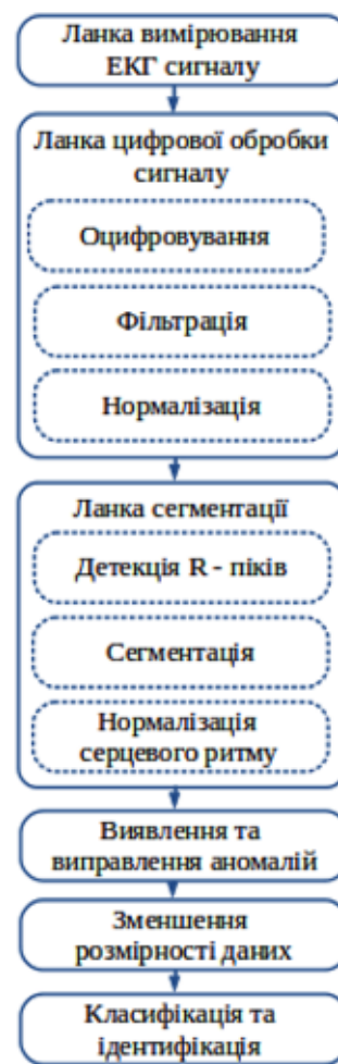
Рис. 2. Структурна схема біометричної системи ідентифікації
